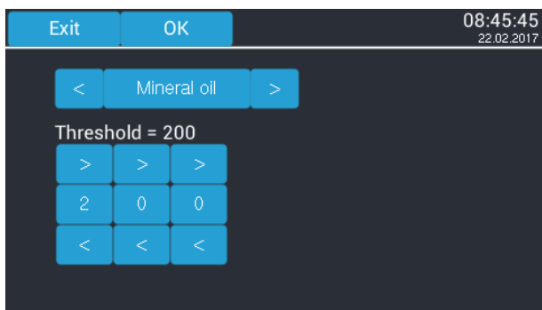
Рис. 13 - Вид дисплея для выбора изоляционной жидкости и параметризации граничного значения H_2
