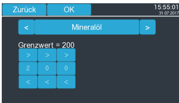
Bild 13 - Displayansicht zur Auswahl der Isolierflüssigkeit und Parametrierung des H 2 -Grenzwertes
